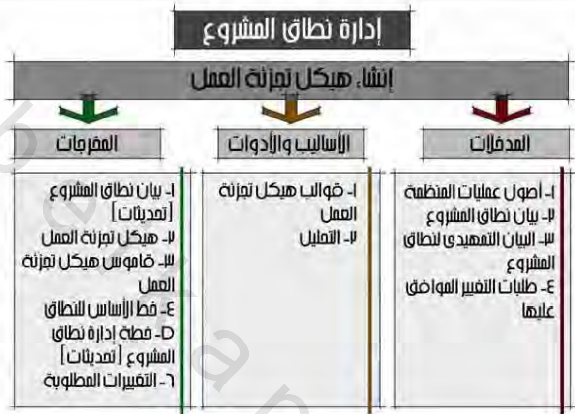
شكل (٢-٢) يوضح إنشاء هيكل تجزئة العمل .
