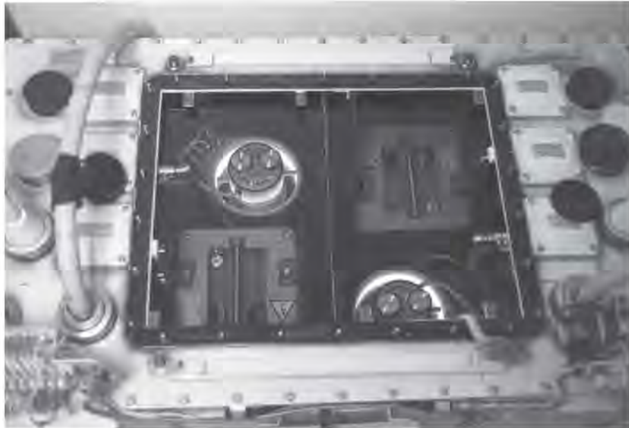
الشكل رقم (٩١،١٧). خزان الجهد العالي مع غطاء مزورع عنه.
