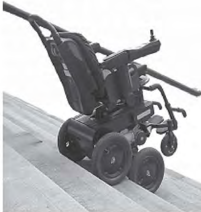
الشكل رقم (١٩، ٩٥). كرسي متحرك ذو تكنولوجيا متقدمة: نظام تنقل INDEPENDENCE™ IBOT™ 3000. إن هذا الكرسي المتحرك قادر على صعود الدرج ونزوله، وعلى الحواف والوقوف على عجلتيه الخلفيتين لوضع راكبه عند مستوى العين بالنسبة لشخص بالغ واقف.
