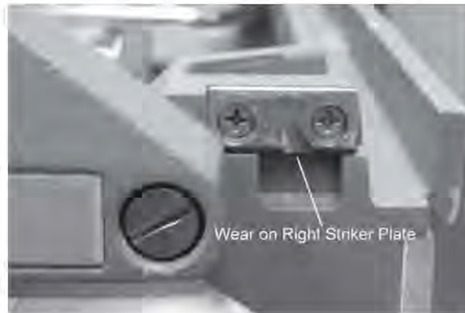
الشكل رقم (٩٥،٨). الصفيحة الضاربة لمزلاج باب حاضنة تبين تآكل المعدن الطري للوحة. لقد مكّن مثل هذا التآكل الرضيع من فتح الباب بمجرد الانكفاء أو الميل عليه. مُستسَخنة بإذن من Shepherd (2003).
