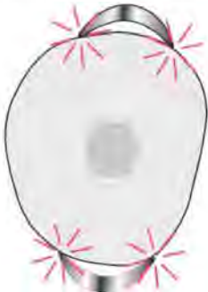
يركز التطابق السيئ لمنقاري الكلابة القوة على نقاط التماس
