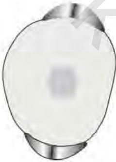
يوزع التطابق المحكم لمنقاري الكلابة القوة بالتساوي
