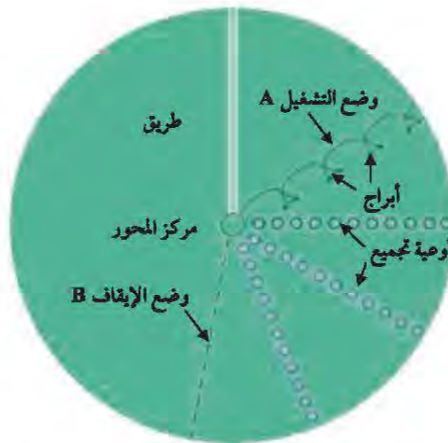
الشكل رقم (١١, ٩). وضع ثلاثة صفوف لأوعية التجميع في نظام الري المحوري.
