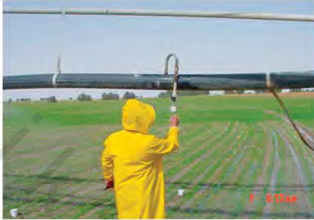
الشكل رقم (١٠, ٩). قياس ضغط الرشاش على خط الرش المحوري.
