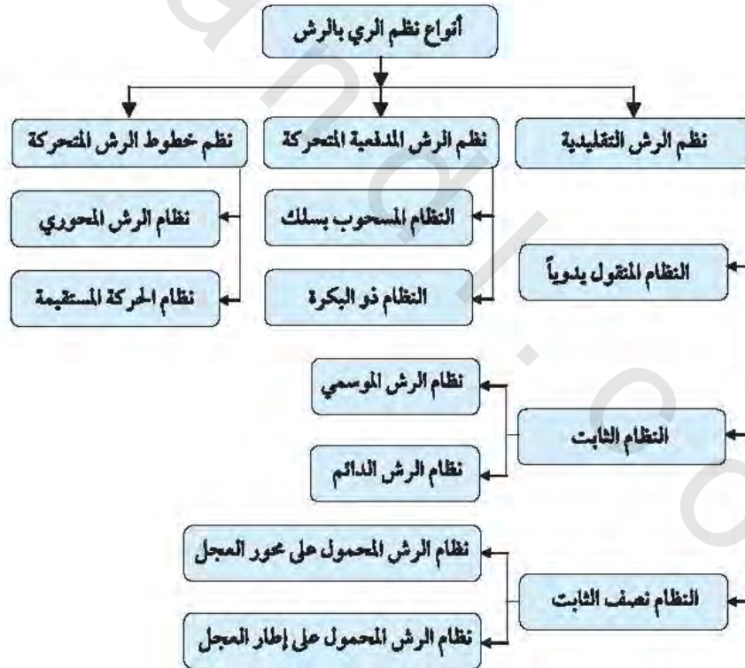
الشكل رقم (١٠، ١٠). أنواع نظم الري بالرش.
