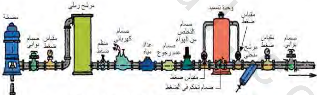
الشكل رقم (١٠, ١٦). مكونات رأس التحكم في نظام الري بالتنقيط.
