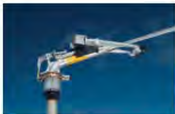
الشكل رقم (٧، ١٠). الرشاش المدفعي ذو الذراع المتأرجح.
