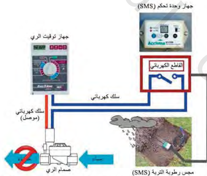
الشكل رقم (٣، ١١). جهاز التحكم يفتح قاطع كهربائي لتجاوز حالة الري بسبب سقوط المطر الذي أدى إلى زيادة المحتوى الرطوبي للتربة المحيطة بالمجس الرطوبي.
