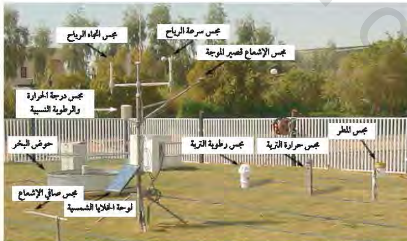
الشكل رقم (٢٠، ١١). صورة لمحطة الأرصاد الآلية مبن بها أجهزة القياس.
