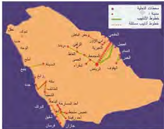
الشكل رقم (١, ٧). موقع محطات التحلية والمدن التي تتلقى المياه المحلاة وخطوط النقل في المملكة.
