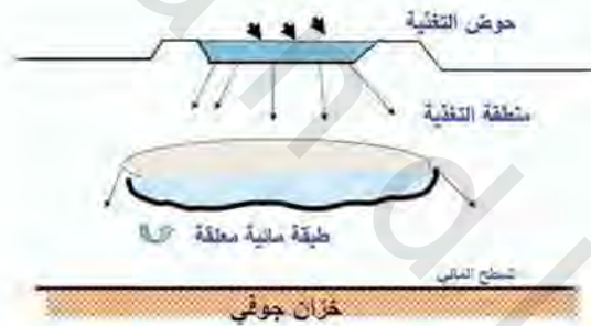
الشكل رقم (٣٧، ٢). طريقة قياس معدل التغذية باستخدام بركة الاختبار نتيجة وجود طبقة معلقة.
