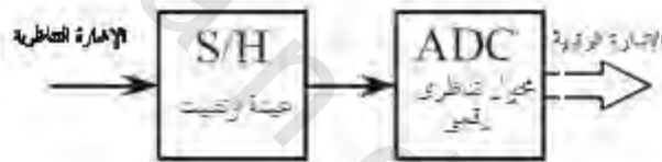
الشكل رقم (٢.١). مراحل تحويل الإشارة التناظرية إلى الصورة الرقمية.
