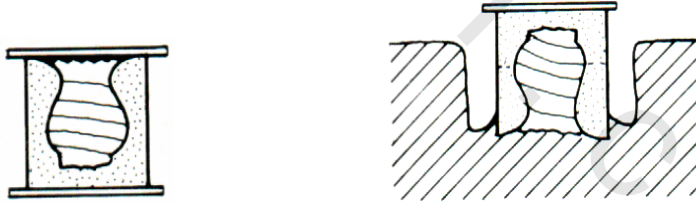
٣ - صب الرغوة على مراحل، وتم إيقاف تمدد ٤ - قلبت الشرنقة وتم تغطية التربة المكشوفة بالرغوة بسدادة من الخشب المضغوط. بالسدادة.
