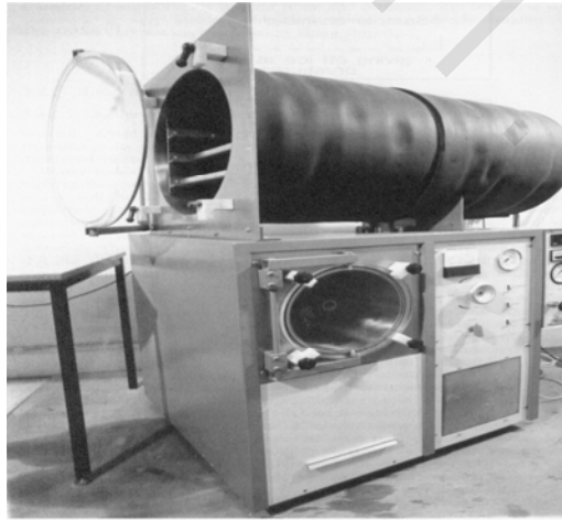
اللوحة (٣، ١٦). جهاز التجفيف بالتجمد : حجرة تفريغ ضخمة موضوعة على وحدة التجفيف بالتجمد .
