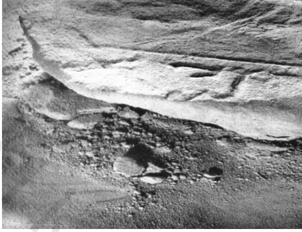
اللوحة (٤,٤). مسلة من الحجر الرملي تفتت بعد مضي سنين عديدة من الحفر نتيجة لفعل الأملاح.
