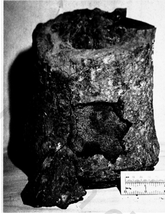
اللوحة (٥,٨). جزء من مدفع تم استخراجه من موقع أثري بحري حيث انفصل جزء من أجزائه الخارجية، التي تحولت إلى جرافيت، من مركز الحديد المصبوب المتبقي.
