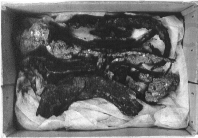
اللوحة (١٣، ٥). تآكل ما بعد الكشف عن القطع الأثرية يتسبب في تفكك الحديد المشغول.
