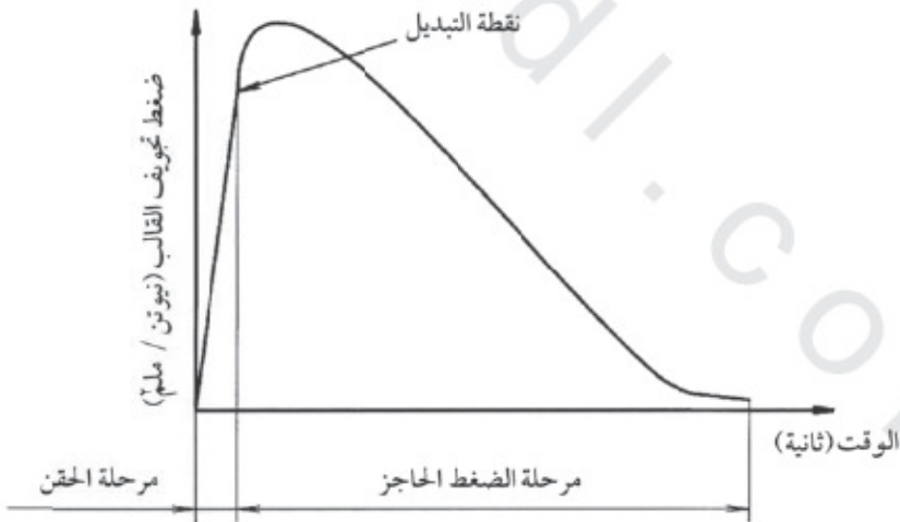
الشكل رقم (٧,٦). منحنى الضغط لتجويف قالب نموذجي.
