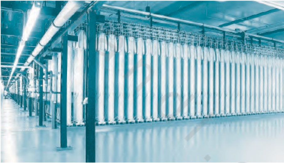
الشكل رقم (١,٩). شلالات تخصيب اليورانيوم بالطرد المركزي [٢٦].
