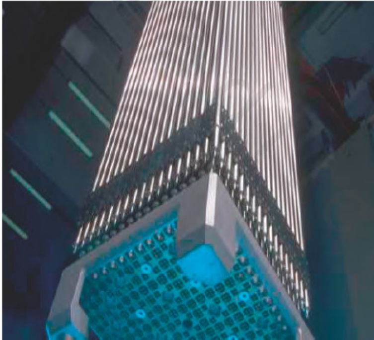
الشكل رقم (١,١٦). حزمة وقود خليط اليورانيوم والبلوتونيوم [٣٩].
