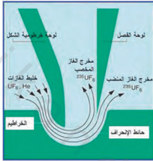
الشكل رقم (١,٥). تخصيب اليورانيوم بالفوهات المنحنية [٣٢].
