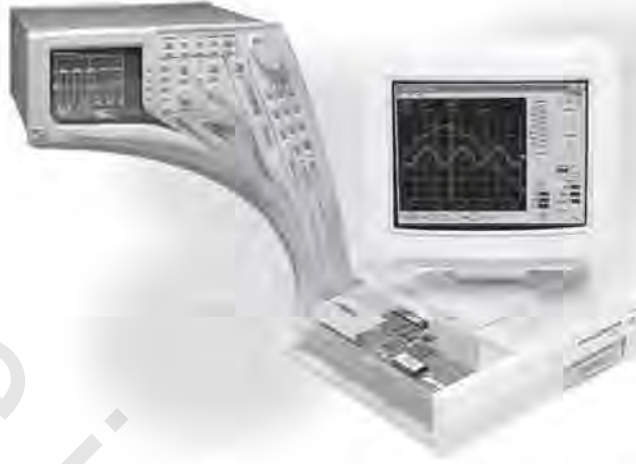
الشكل رقم (١، ١٣٦). الأجهزة الافتراضية: نسخ وتعزيز أجهزة تقليدية "معروفة بالائع" بواسطة أجهزة افتراضية "معروفة بالمستخدم" (مواصفة شركة National Instruments).
