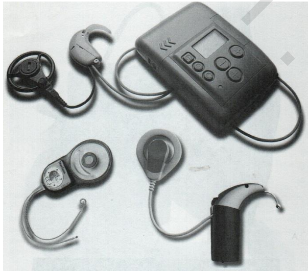
الشكل رقم (٢،٨). نوعان من أدوات السمع المزروعة ومعالجات الكلام.
