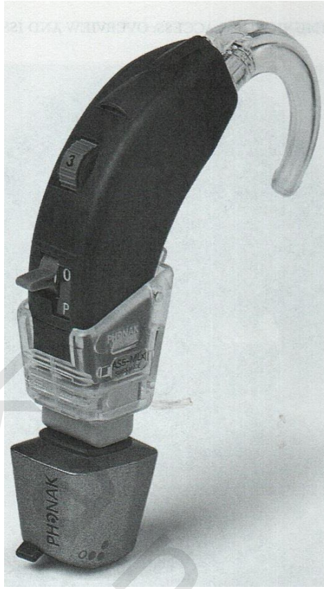
الشكل رقم (١٢.٢). سماعة خلف الأذن مزودة بنظام تضمين التردد.
