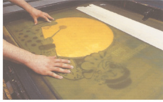
١ تثبيت الاستنسل الشبكي ملاصقاً مع سطح الورق
