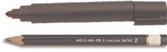
قلم رصاص 2 B قلم سبورة يستخدم لوضع العلامات والأرقام على فيلم الاستنسل مع امكان محو آثارها بسهولة من على ورق الاستنسل
