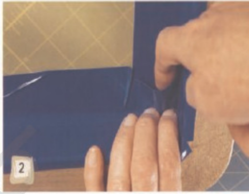
٢ التاك من عدم وجود فراغات ينفذ منها الحبر الطباعي
