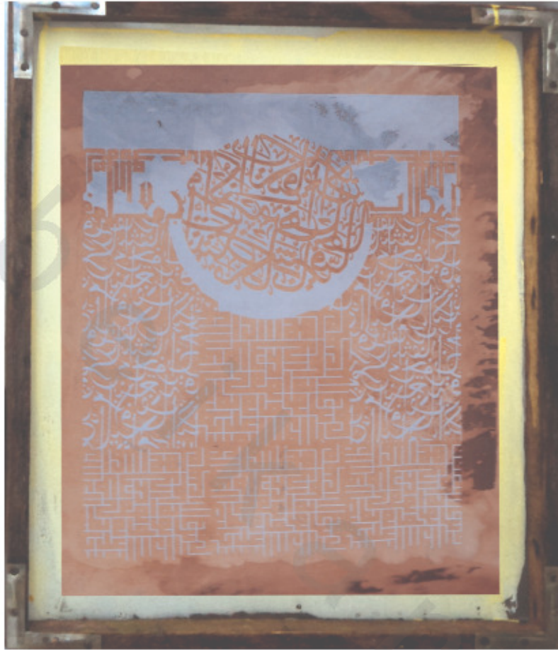
شكل ( ١٢٣ ) استنسل فونوغرافي على الحزير وجاهز للطباعة على سطح المعدن
