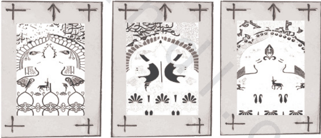
شكل ( 110 ) يوضح شكل علامات التطابق اللوني
