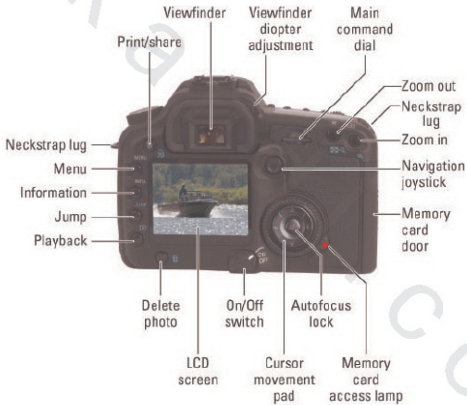
شكل (٢٤٦) أجزاء آلة التصوير العاكسة الرقمية ووظائفها DSLR Camera Controls on the Front on the Back المصدر
