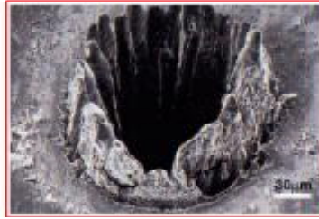
(ثقب الصلب بواسطة الليزر)
