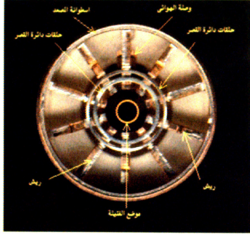
شكل رقم (٤ د) تأثير كل من المجال المغناطيسى والمجال الكهربائى على حركة الإلكترونات داخل الماجنترون
