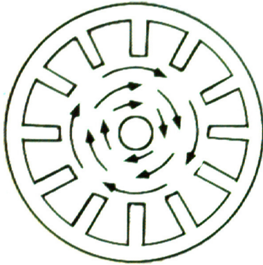
شكل رقم (٤د) منظر علوي لحركة الإلكترونات تحت تأثير المجال المغنطيسي داخل الماجنترون
