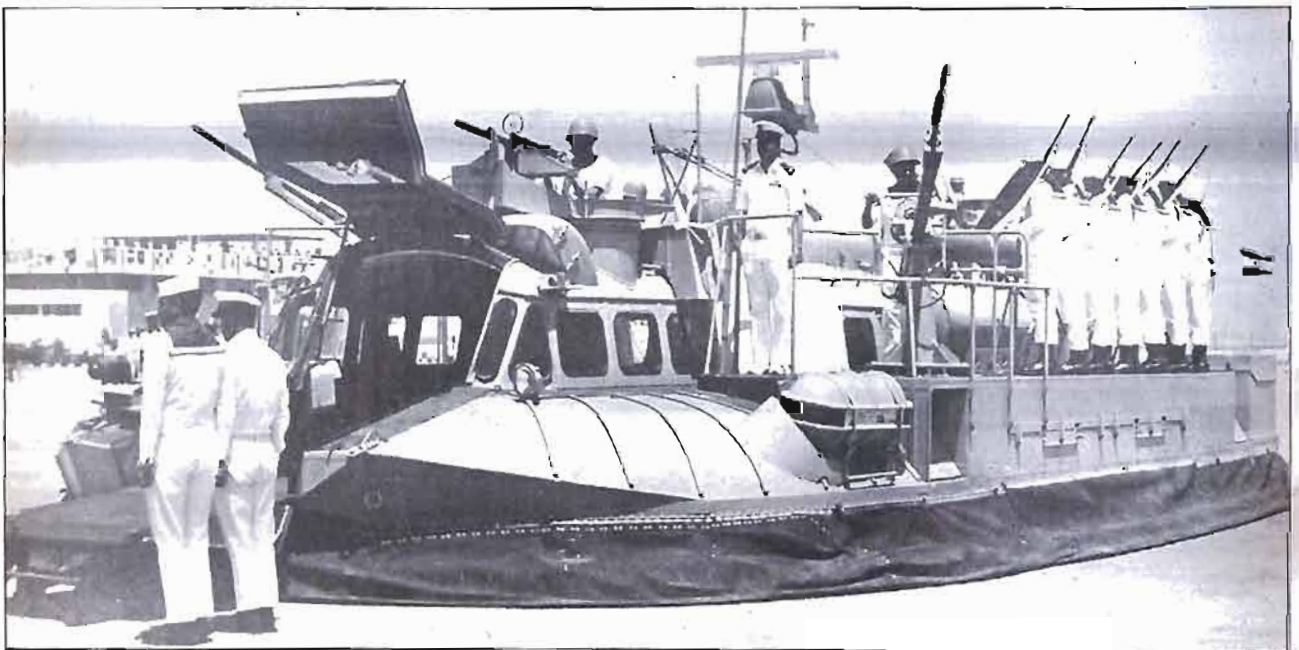
الحوامة أو زورق الوسادة الهوائية أو «المفر كرافت» أحدث الوحدات البحرية في العالم. طوله ١٥ متراً وعرضها ٧ أمتار وارتفاعها أقل من ٥ أمتار بعشرين سم. أصبحت ضمن التشكيل القتالي في الوحدات الخاصة البحرية.
