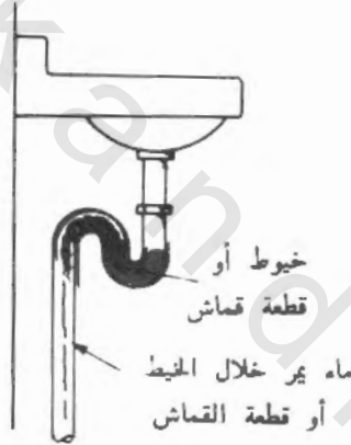
الشكل رقم ١٢/١ إستقرار خرقة قماش أو بعض الخيوط في محبس الروائح، يعمل على تدمير كمية الماء التي تعمل كمانع للتسرب
