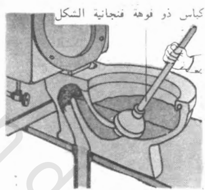
الشكل رقم ٤/٢٠ استخدم الكباس ذو الفوهة فنجانية الشكل المصنعة خصيصاً للمراض، لإزالة الانسداد من محبس الروائح بالمراض
