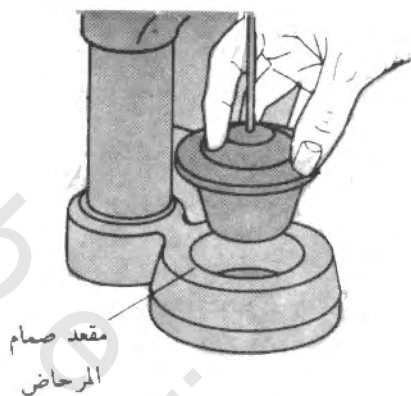
الشكل رقم ٤/١٩ ادفع السدادة في مقعد الصمام
