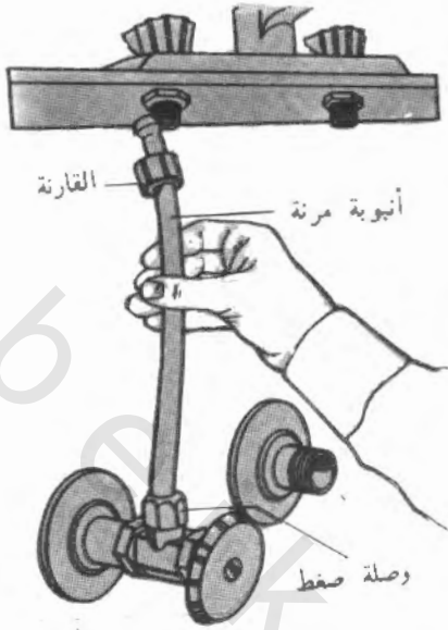
الشكل رقم ٧/١٤ تعليق المحبس إلى الأداة الصحية يكون بتثبيت القارئة والوصلة على الأنبوبة المرنة القابلة للتشنية
