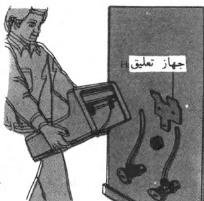
الشكل رقم ٧/١٥ رفع الحوض من جهاز التعليق، ويكون ذلك برفعه رأسياً إلى أعلى
