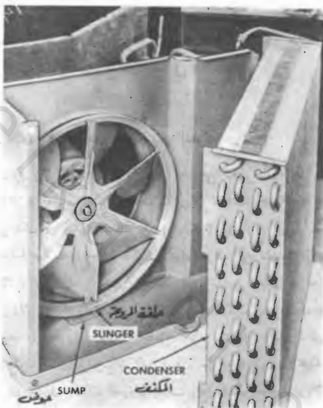
رسم رقم (٢ - ١٠) - الحلقة التي تحيط بمروحة المكثف والتي تقوم برش الرطوبة المتكاثفة على سطح مواسير وزعانف المكثف الساخنة لتعمل على تبخيرها وذلك لزيادة تبريد المكثف وتحسين جودة دائرة التبريد .
