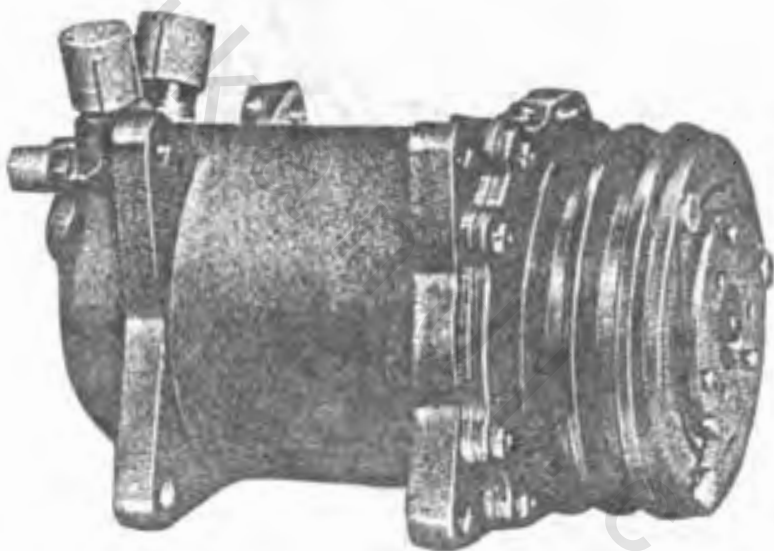
رسم رقم ( ٩ - ٢٢ ) - الشكل الخارجى لضاغط دائرى ذى ريش متحركة من طراز ( سايكو - سيكى ) اليابانى .
