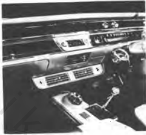
رسم رقم (٩ - ٤) تركيب مجموعة المبخر أسفل لوحة أجهزة القياس الموجودة أمام السائق
