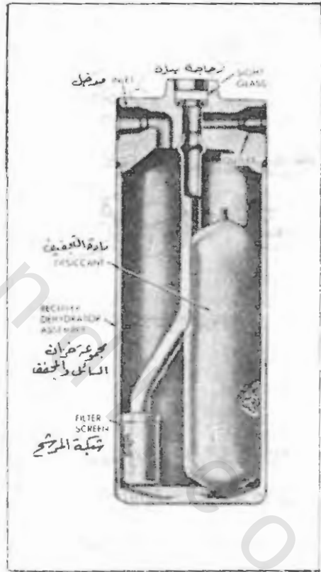
رسم رقم ( ٢٧-٩ ) - شكل وتركيب مجموعة تخزين السائل والجفاف والتي تشتمل على زجاجة بيان في نفس الوقت .
