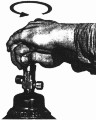
شكل ١١ - ١٠ طريقة طرد الغبار من أسطوانة الأوكسجين ٥. تفقد أسنان قلاووظ الاسطوانة وأسنان
