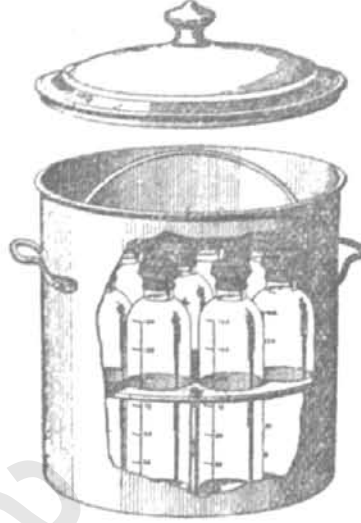
( شكل ٦٦ ) جهاز الاستاذ بودين لتعقيم اللبن
