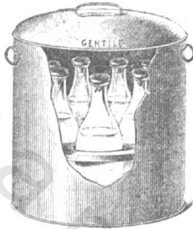
( شكل ٦٣ ) جهاز جانتيل لتعقيم اللبن
