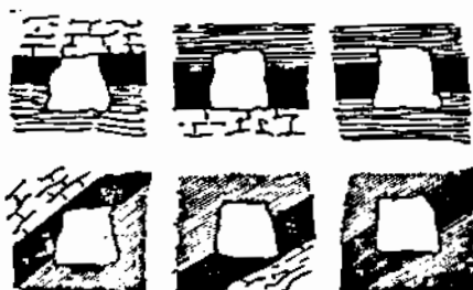
( شكل ٤٦ ) مواقع الممرات في الصخور الطبقية
