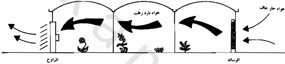
شكل ( ٣ - ٨ ) : مسار الهواء فى البيوت المبردة بنظام المروحة والوسادة .
