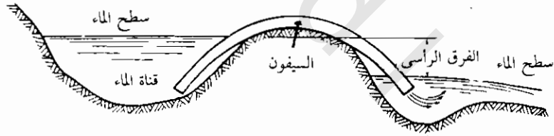
شكل (٦ - ٦) : الفارق الرأسى (head) فى نظام الرى بالسيفونات .
