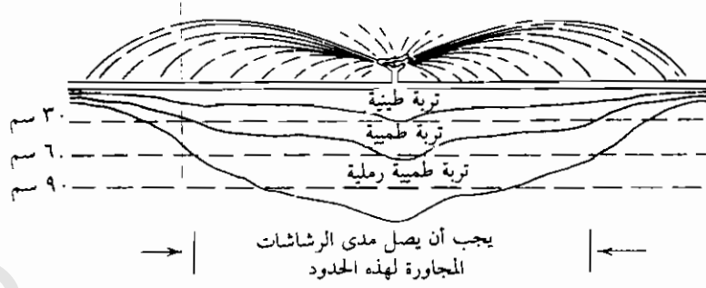
شكل (٦-٩): مقطع التربة المبتل بالماء من رشاش واحد في الأنواع المختلفة من الأراضي .
