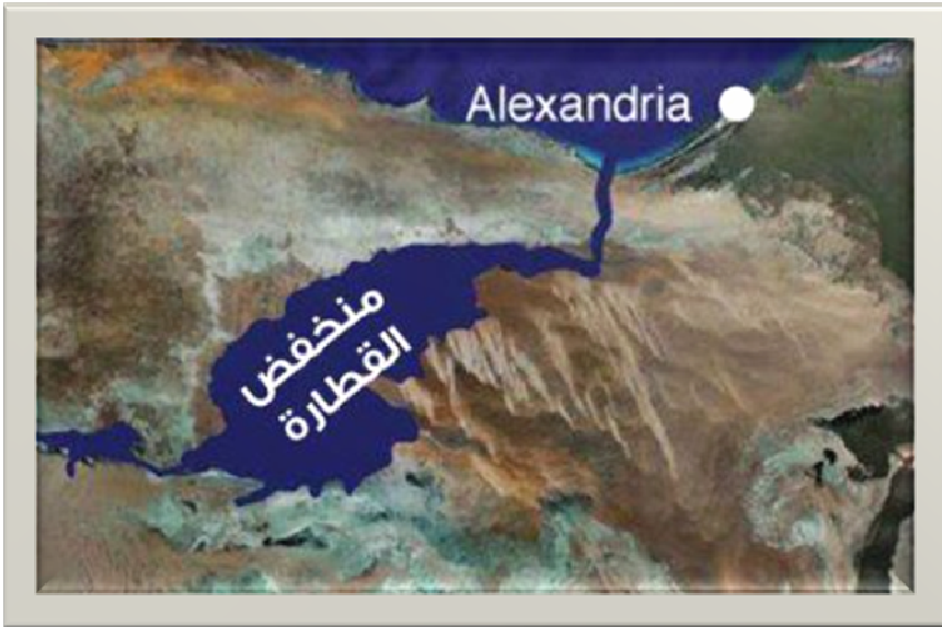
(خريطه توضح المقترح الأول لمشروع منخفض القطارة بتوصيل مياه البحر للمنخفض لتوليد الكهرباء)
