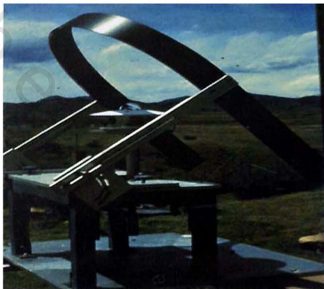
شكل ( أ - ٥ ) : جهاز البيروميتر ، لقياس الإشعاع الصادر من الشمس في المناطق الصحراوية أو في أي منطقة أخرى
