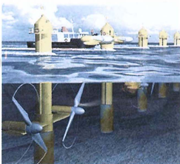
شكل (٩): عدد من التوربينات مثبتة أسفل الماء
