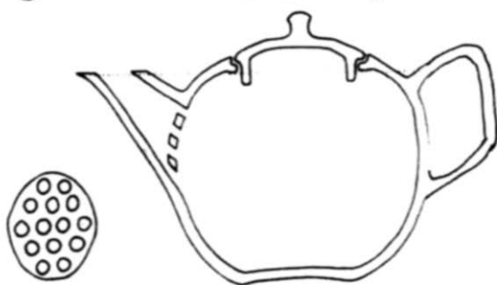
قطاع عرضى فى إبريق الشاى ورسم يوضح أشكال ثقبو التصفية
