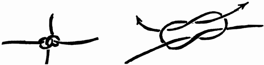
طريقة عقد حبلين لوصل طرفهما بحيث يكون الطرفان القصيران الناتجان عن العقدة في وضع متعامد مع الحبلين الموصولين
